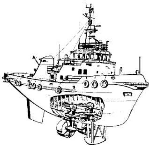
Sleepboot met roerproPELLERS en straalbuizen
